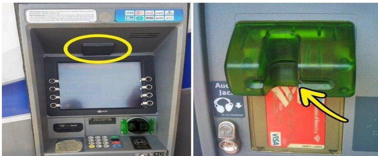
Obraz 5 Przykład zmodyfikowanego bankomatu ze wskazaniem miejsc instalacji skimmera oraz ukrytej kamery rejestrującej kod PIN.
