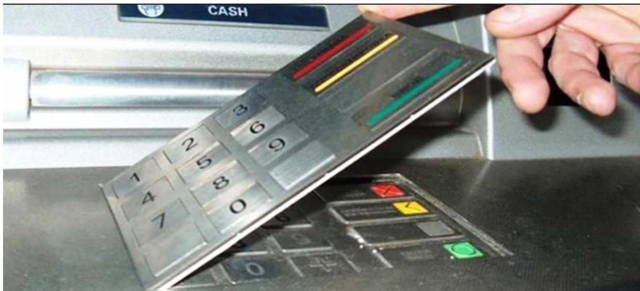
Obraz 6 Nakładka rejestrująca wprowadzane znaki instalowana przez sprawców skimmingu.
